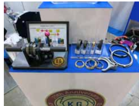
シンクロナイザー動作デモ機 量産品(レバー/銅合金/鉄樹脂シンクロナイザー・シフトフォーク)
